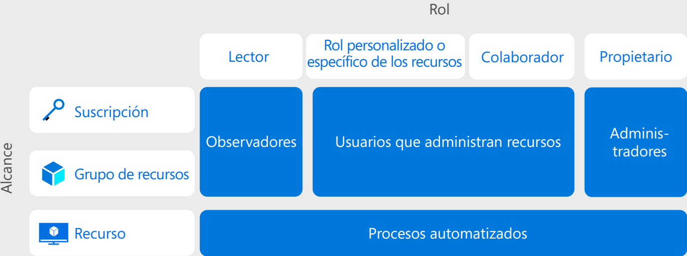
Figura 9. Patrón para asignar el control de acceso basado en roles de Azure (RBAC)
